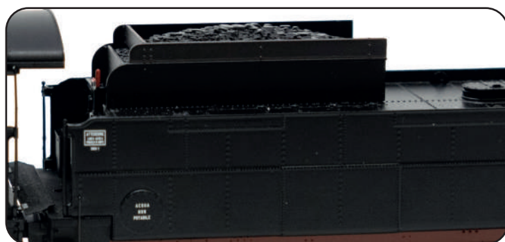
Tender con sopralzo carboniera e chiodature aggiuntive
