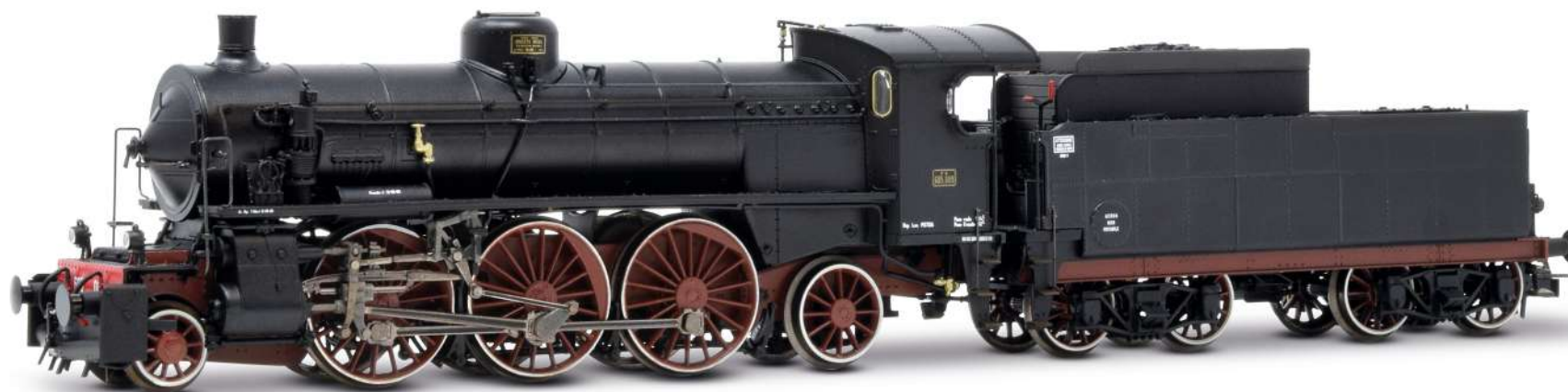
Tender con sopralzo carboniera e chiodature aggiuntive
