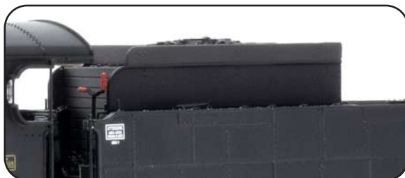
Tender con sopralzo carboniera e chiodature aggiuntive
